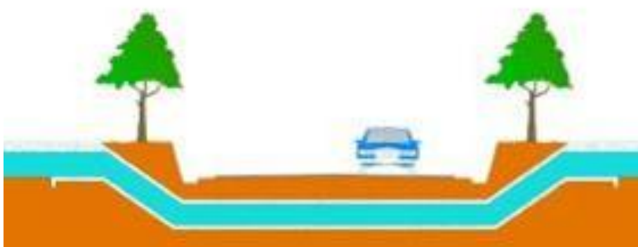
Gambar 9. Bangunan Siphon Drainase
