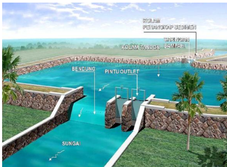
Gambar 38. Pintu air kolam retensi di dalam badan sungai
