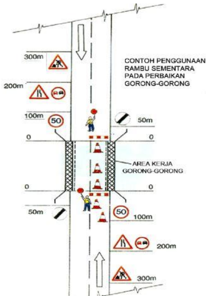
Gambar 35. Keselamatan Kerja Pekerjaan Crossing
