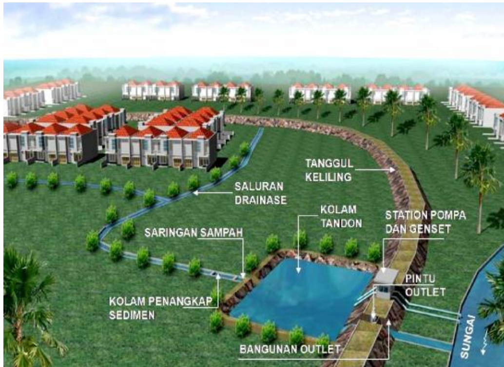
Gambar 40. Pintu air sistem polder dengan pompa dan kolam di badan saluran drainase
