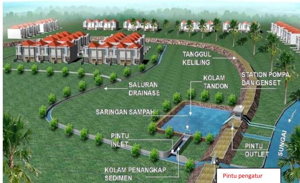
Gambar 39. Pintu air sistem polder dengan pompa dan kolam di samping saluran drainase
