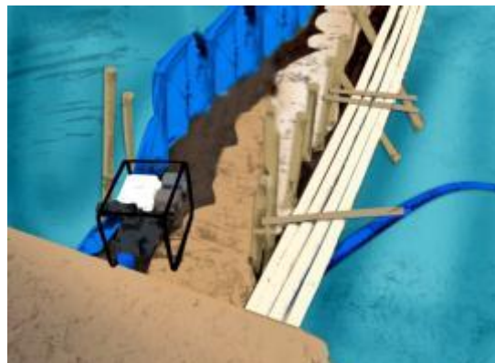
Gambar 76. Proses Pengeringan Air Dengan Pompa
