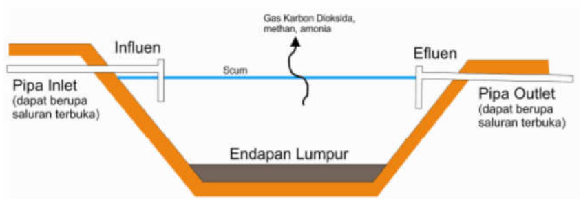
Gambar 15 Ilustrasi pengolahan pada kolam anaerobik
